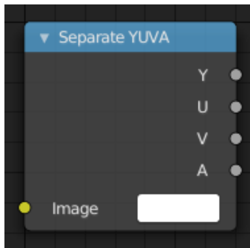
Fig. 364: Separate YUVA Node.
